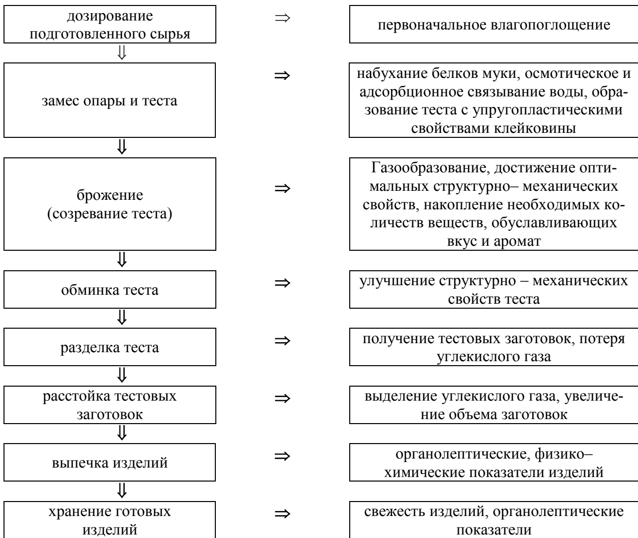
Рис. 2. Параметрическая модель технологии изделий из дрожжевого теста
